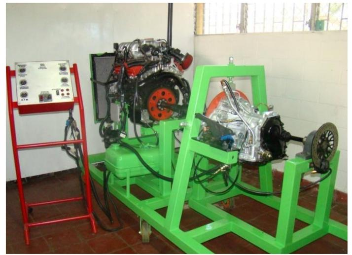
Equipo automatizado para pruebas de cajas de transmisión automática de vehículos
