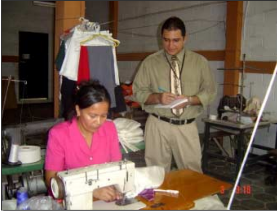
Toma de tiempos y movimientos de los procesos de producción realizados en las microempresas en estudio.
