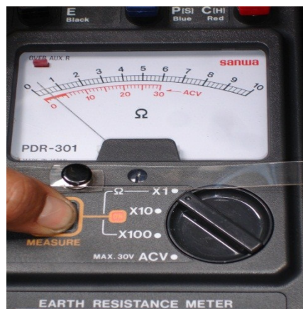
Figura 4. Comprobación de la lectura utilizando un Telurómetro Analógico R = 0.4 \Omega
