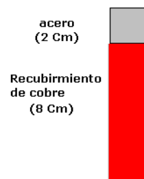
Figura 2. Forma de preparar el trozo cortado de la barra, para soldar a la solera de fundación
