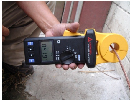
Fotografía 3. Lectura del Telurómetro Digital R = 0.419 \Omega
