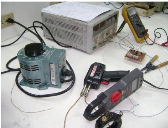
Figura 2. Pruebas de circuito de medición de corriente.
