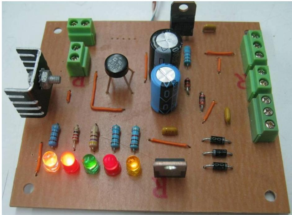
Fig. 12. Fuente de alimentación del sistema
