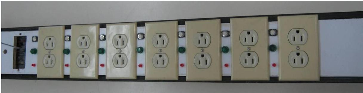
Fig. 17. Módulo de conexión / desconexión de cargas
