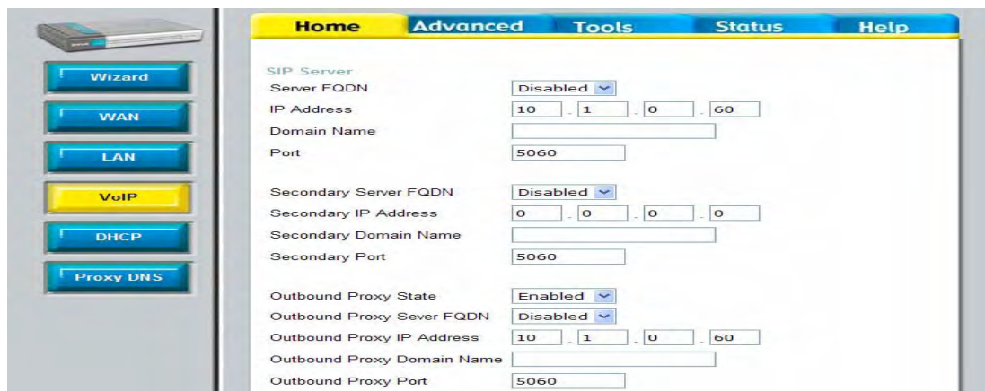
Figura No. 73 Configuración de Server Voip.
