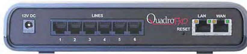
Figura No. 15– Pasarela FXO (FXO Gateway) con 6 interfaces (lines) FXO.
