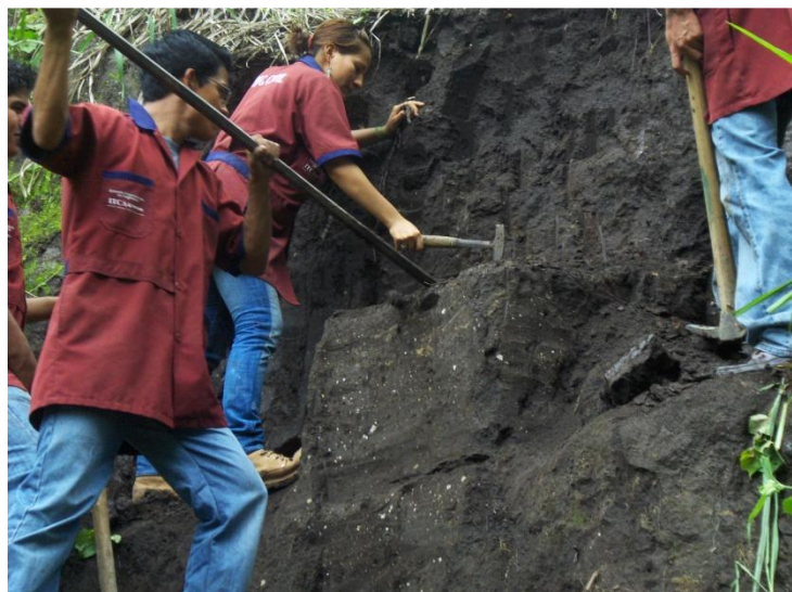
Estudiantes de la Escuela de Ingeniería Civil y Arquitectura de ITCA-FEPADE realizando muestreos para estudios de suelos
