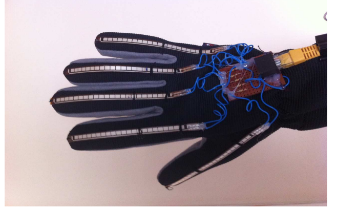
Şekil 3: Esneklik algılayıcı sensör bağlantıları.
