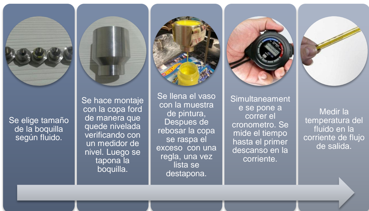
Ilustración 13. Procedimiento para la prueba de viscosidad empleando la copa Ford.
