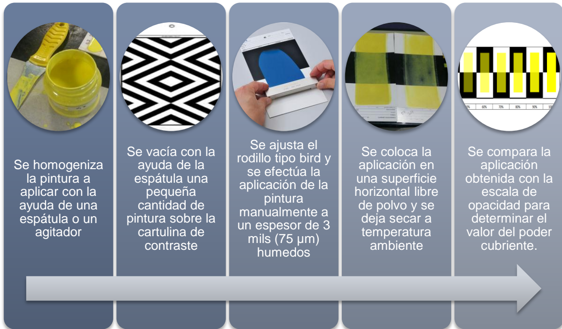
Ilustración 15. Procedimiento para la realización de la prueba de poder cubriente.
