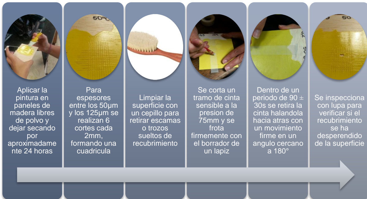
Ilustración 11. Procedimiento para la prueba de adhesión por el método de la cinta.
