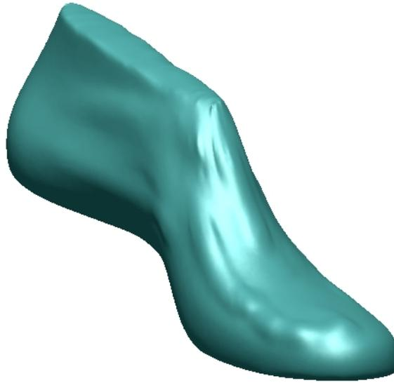
*Ilustración 15. Horma uno y dos registradas para verificación dimensional*
