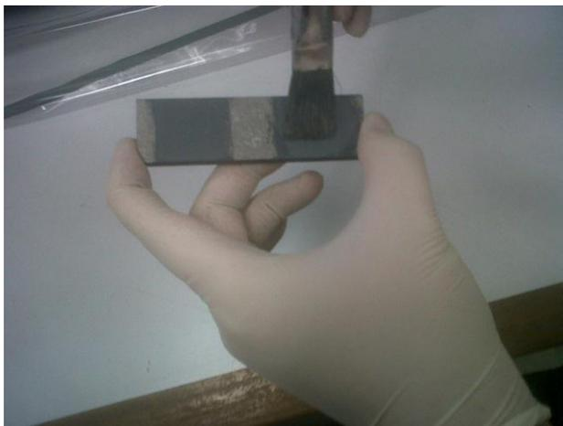
Ahora, para las probetas que requieren sólo adhesivo (Tipo 1 y 2) o aquellas a las que se les aplica el adhesivo luego del primer (Tipo 3 y 4), se sigue el procedimiento descrito en el Anexo 2 y se deja secar en una mufla a 60°C, como se muestra en la Figura 9.
