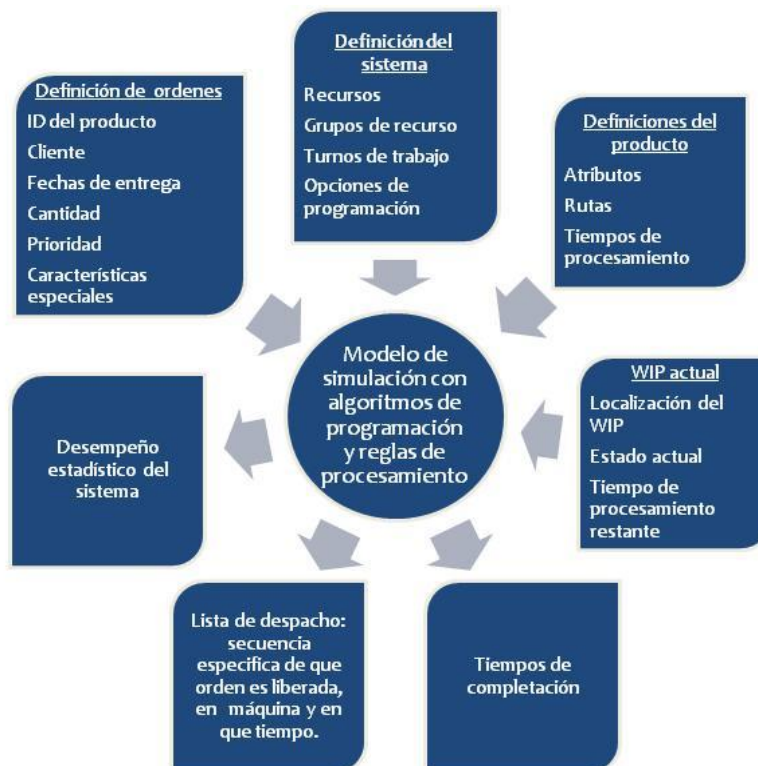
Ilustración 5. Estructura del programa de simulación
