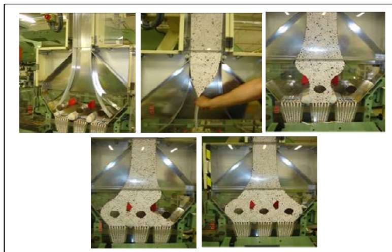
Figura 25. Bandas de llenado de tolva de empaquetado.
