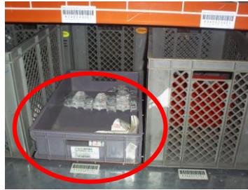
Ilustración 26. Unidades de almacenamiento ubicadas en módulos diferentes de las estanterías a los asignados
