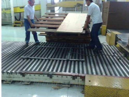
Figura 54 .Operarios Depositando la Estiba Sobre el Dispositivo
