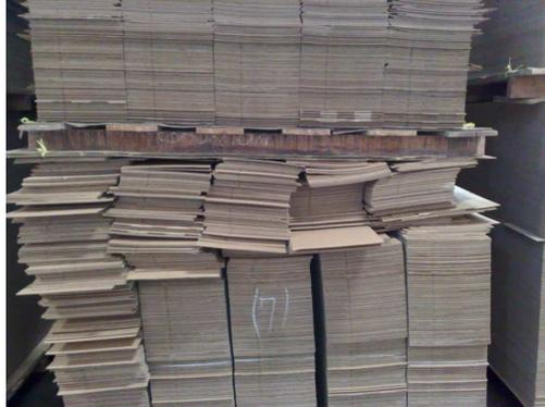
Figura 62. Desperdicio Controlable Generado por un Error al Ubicar las Estibas.
