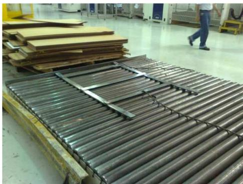
Figura 53. Dispositivo Metálico Usado para Depositar la Estiba de Madera.
