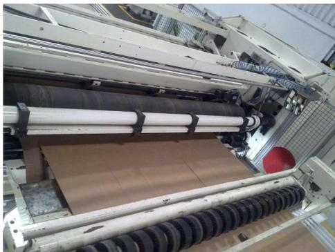
Figura 23. Máquina Cortadora y Hendedora Longitudinal de la Fábrica de Cajas de C.I. Unibán S.A.
