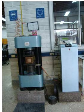
Figura 111. Prensas hidráulica ELE con una muestra.
