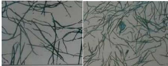
Figura 5. Fibras Largas de Coníferas (izquierda) Fibras Cortas de Frondosas (derecho).
