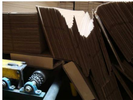
Figura 129. Fractura de la estiba en el momento de la devolución del tren alimentador.
