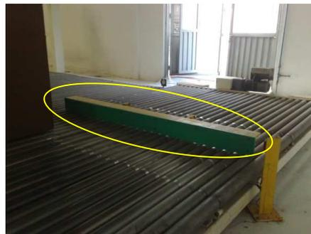
Figura 57. Empujador del Sistema Apilador.
