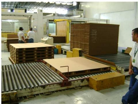
Figura 28. Sistema Apilador de la Fábrica de Cajas de C.I. Unibán S.A.
