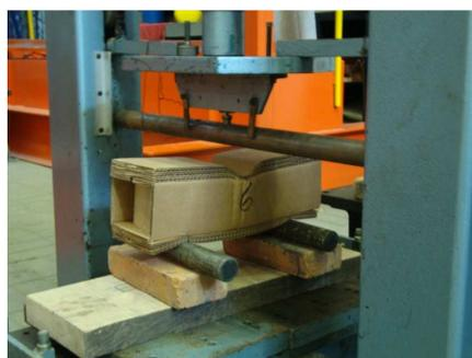
Figura 122. Muestra # 6 momentos después de sufrir su máxima resistencia a la flexión (4445 N).
