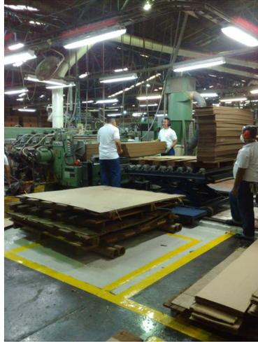
Figura 61. Alimentación de la Máquina Flexográfica.
