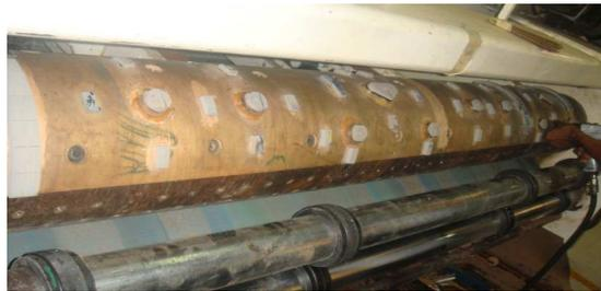
Figura 36. Troquel montado en el cilindro del cuerpo troquelador.
