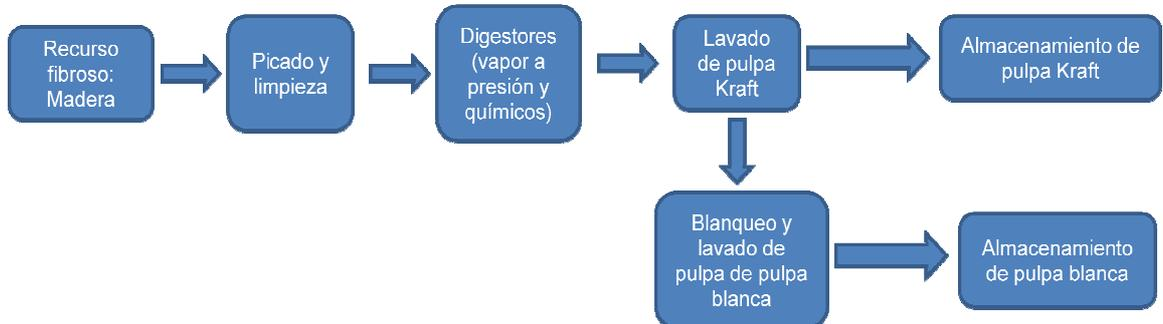
Figura 4. Proceso de Producción de Pulpas Kraft y Blancas.
