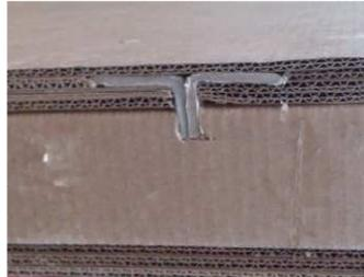
Figura 87. Refuerzo de esquineros en la plataforma superior.
