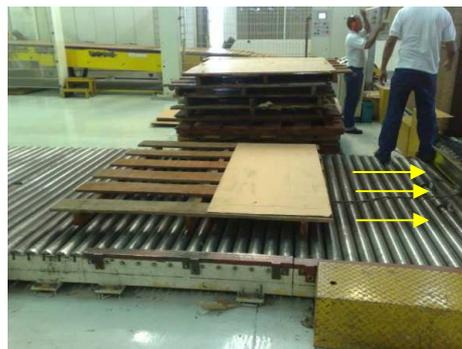
Figura 55.Desplazamiento de la Estiba por el Colchón de Rodillos.
