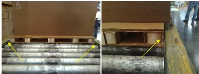
Figura 105. Problema entre el tren alimentador de la flexo 37 y la estiba de papel tipo sencilla.
