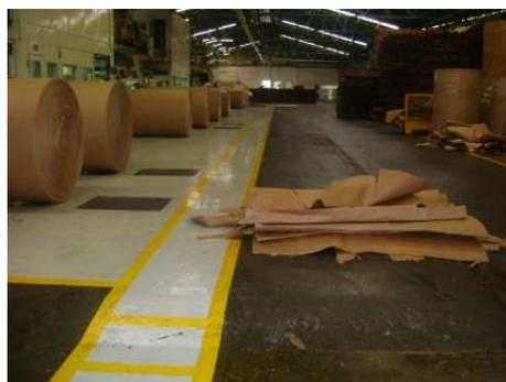
Figura 64. Láminas de Desperdicio de Papel generadas Luego de la Preparacion del Rollo de Papel.
