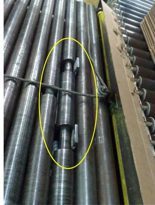
Figura 56. Platinas Aseguradoras de Estiba.
