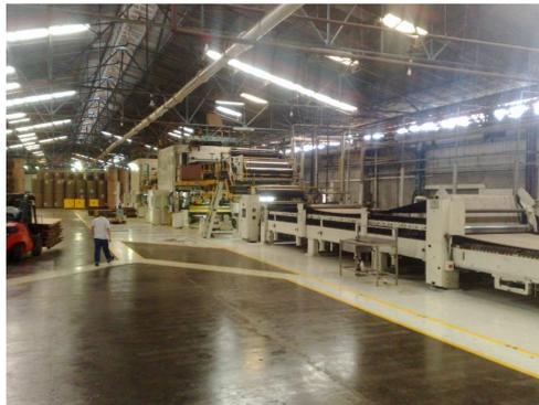
Figura 16. Máquina corrugadora de la Fábrica de Cajas de C.I. Unibán S.A.
