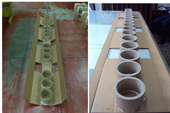
Figura 130. Imagen del larguero con el diseño anterior y el larguero con el nuevo diseño, respectivamente.
