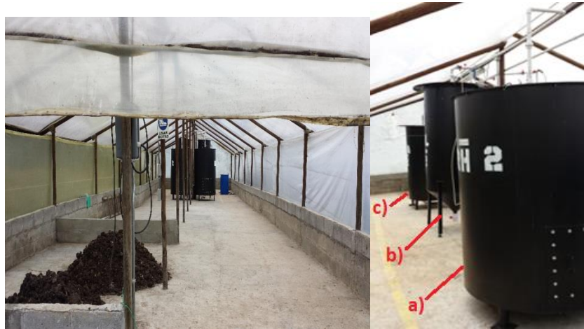
Figura 2.9. Sistema piloto de digestión en el relleno sanitario del Carmen de Viboral [57].
