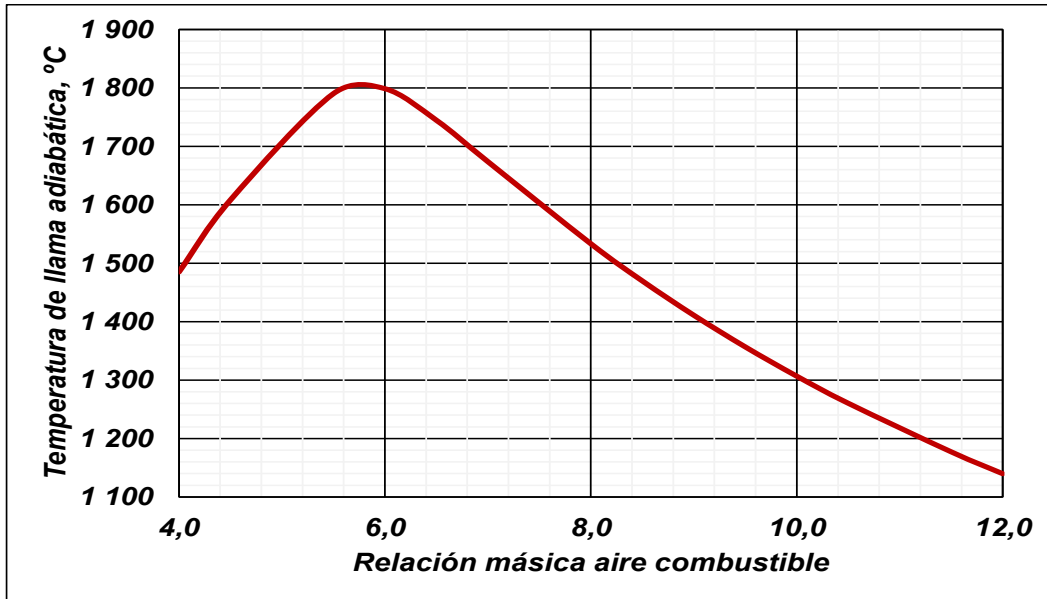
Figura 4.17. Curva de temperatura de llama adiabática contra la relación másica aire combustible para la combustión del biogás generado en planta.
