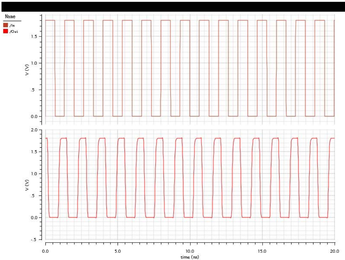
Figura 4-22: Respuesta del Buffer Retardador-Inversor
