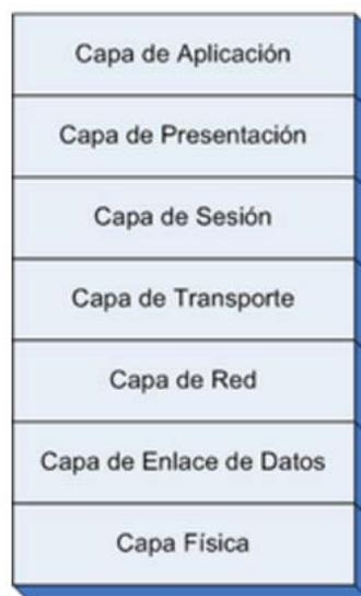
*Ilustración 1 - Capas del modelo de referencia OSI*
