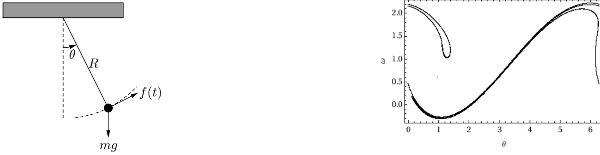
Figura 1. El péndulo forzado amortiguado. La variable dinámica es \theta ; f(t) es un forzamiento armónico definido por f(t) = f_0 \cos(\omega_f t) (panel izquierdo). Sección de Poincaré para G = 1,2 , q = 2 y \omega_D = 2/3 , los puntos son tomados cada periodo de forzamiento (panel derecho).
