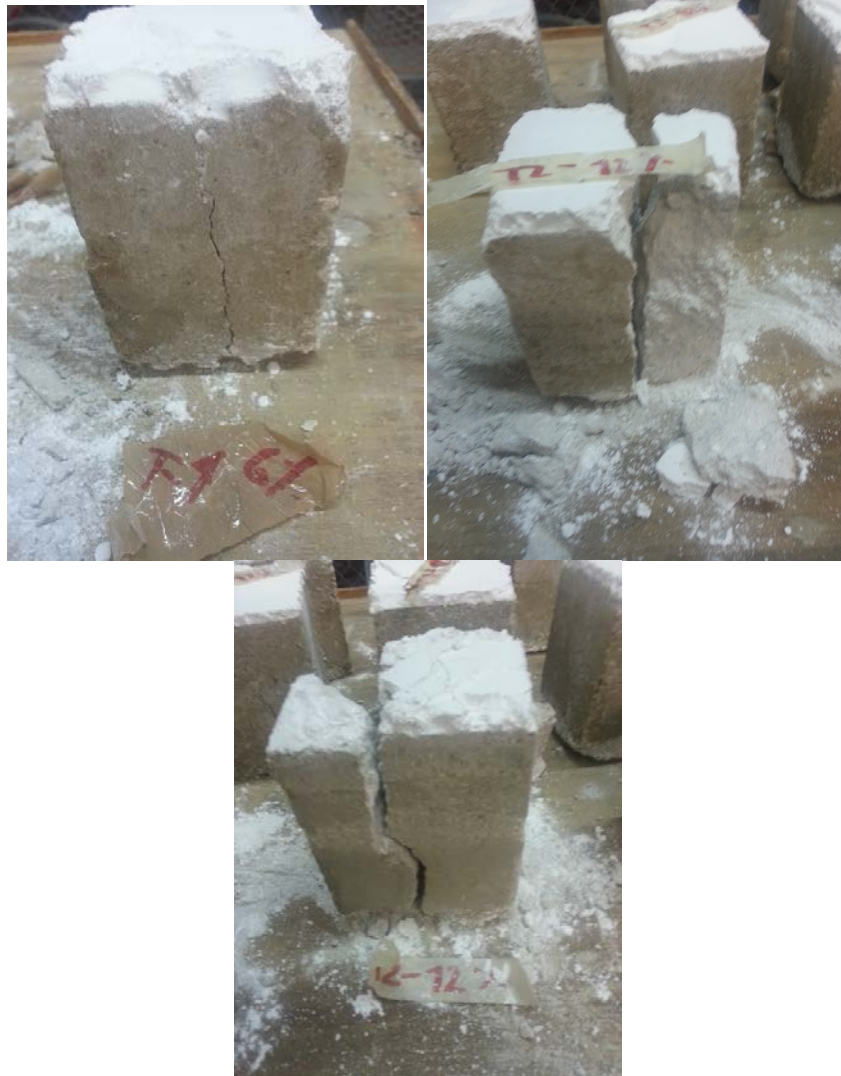
Fotografía 16, 17 y 18: Fallas típicas en las pruebas de Resistencia a Compresión: Elaboración Propia.
