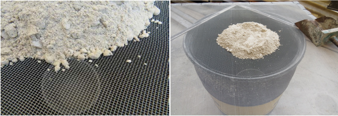
Fotografía 1 y 2: Proceso de cribado en malla#16, abertura de 1.19mm. Elaboracion Propia.
