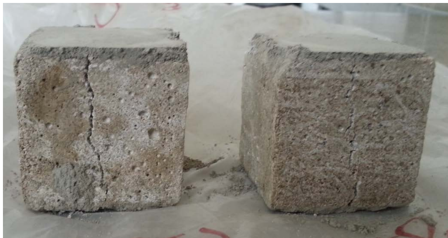
Fotografía 13: Fallas típicas en las pruebas de Resistencia a Compresión: Elaboración Propia.
