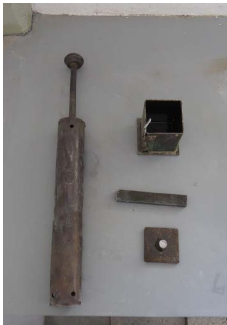
Fotografía 10- Herramientas para la compactación de la probeta. Elaboración propia
