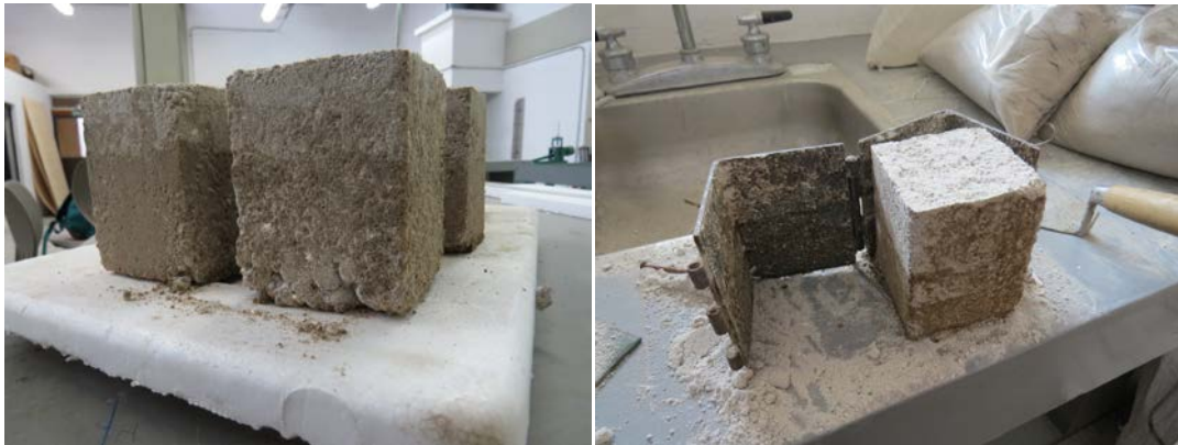
Fotografía 11 y 12: Probeta antes de probarla en la prensa. Elaboración propia.
