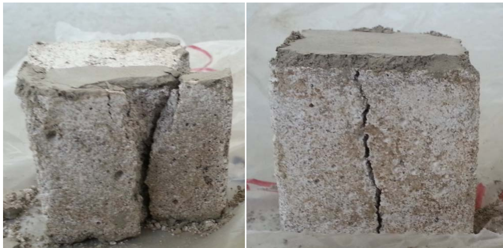
Fotografía 14 y 15: Fallas típicas en las pruebas de Resistencia a Compresión: Elaboración Propia.
