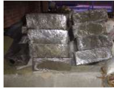
Figura 10. Curado de Bloques
