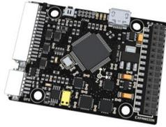
Fig. 12. PX4 FMU. Piloto automático de la empresa 3D robotics.
