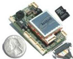
Fig. 9. Kestrel autopilot V3.0. Piloto automático de la empresa Lockheed Martin.
