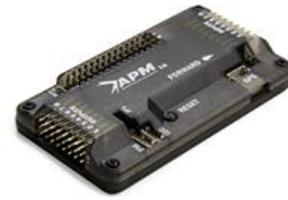
Fig. 14. APM 2.6 set. Piloto automático de la empresa 3D robotics.
