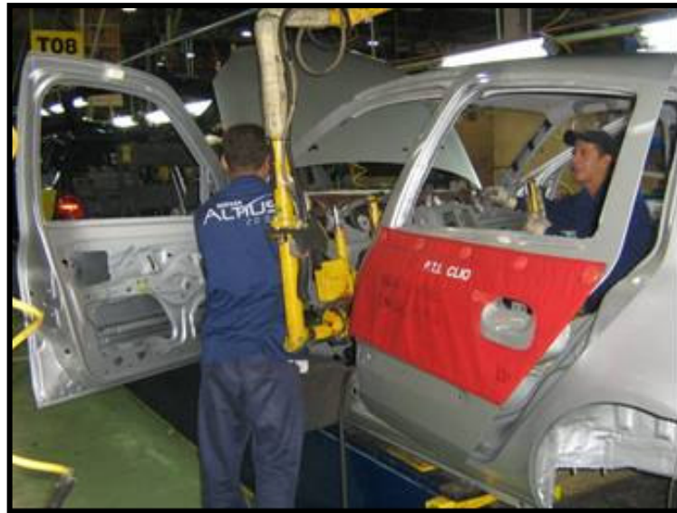
Figura 21 Montaje de tablero.
