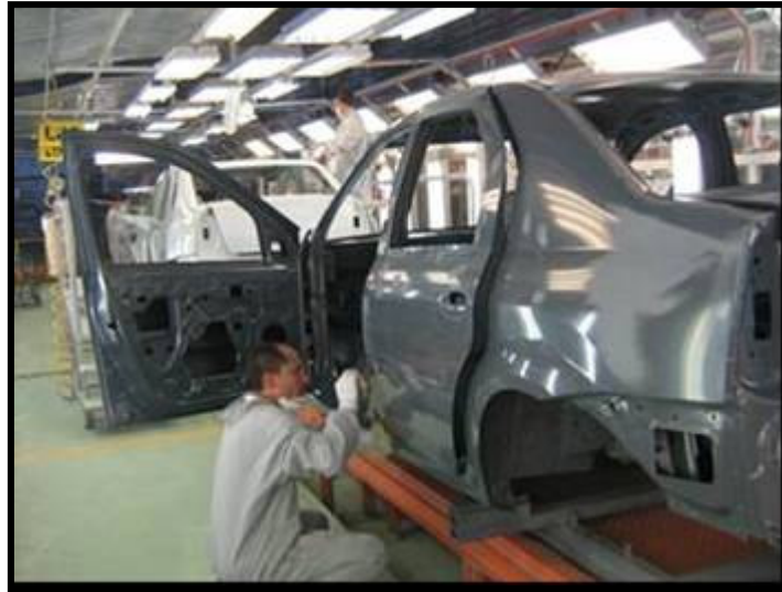
Figura 16 Línea de lijado
