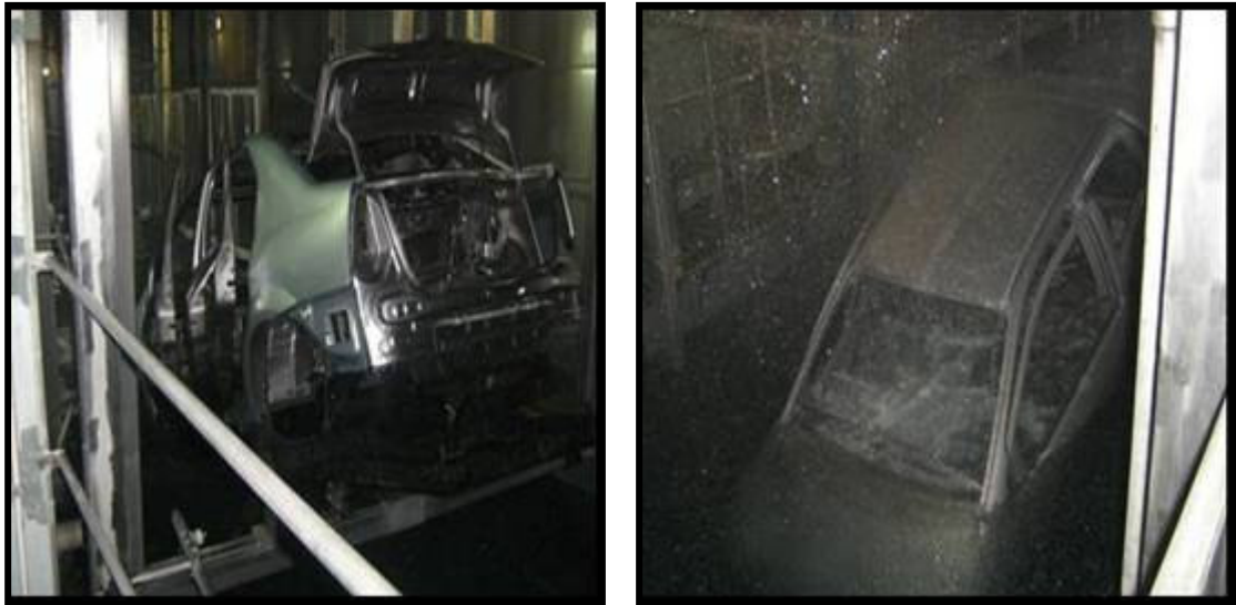
Figura 12 Tunnel de tratamiento de superficies (TTS)
