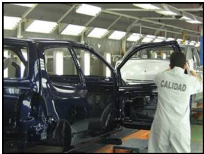
Figura 18 Inspección de calidad línea de terminación.
