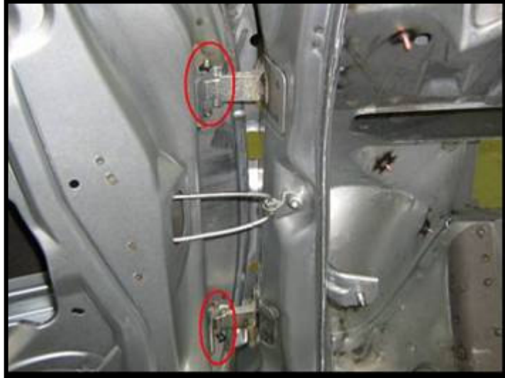
Figura 11 Pines de fijación en bisagras Megane.
