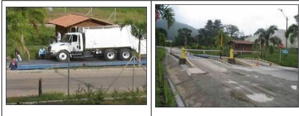
Ilustración 14 Bascula de pesaje parque industrial La Pradera
