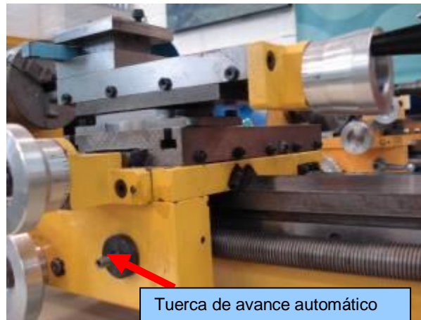
Ilustración 48. Tuerca de avance automático del conjunto del carro
