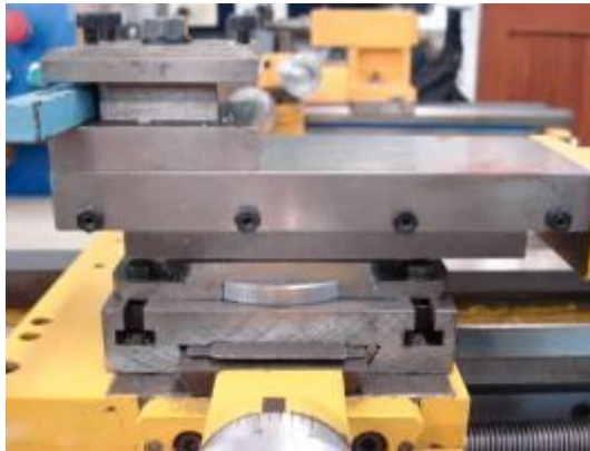
Ilustración 39. Sistema de sujeción de los carros transversal y superior
