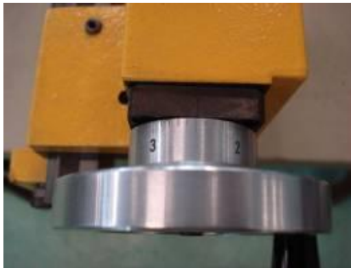
Ilustración 44. Volante con escala grabada del contrapunto
