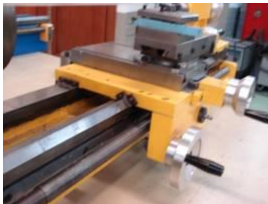
Ilustración 33. Conjunto del carro sobre las guías de la bancada
