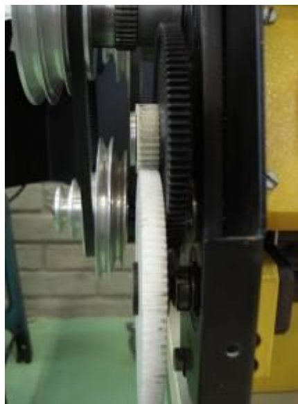
Ilustración 49. Engranajes que permiten el avance automático del carro
