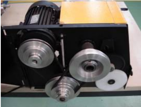
Ilustración 46. Sistema de transmisión por correas
