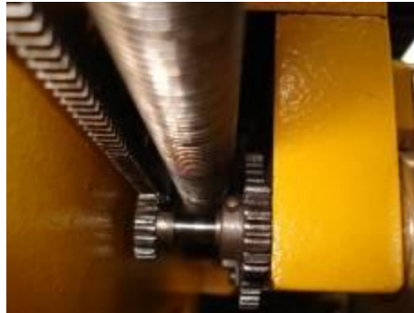
Ilustración 41. Sistema de movimiento del conjunto del carro
