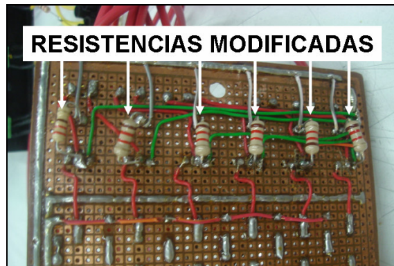
Ilustración 35. Resistencias en la tarjeta de amplificación
