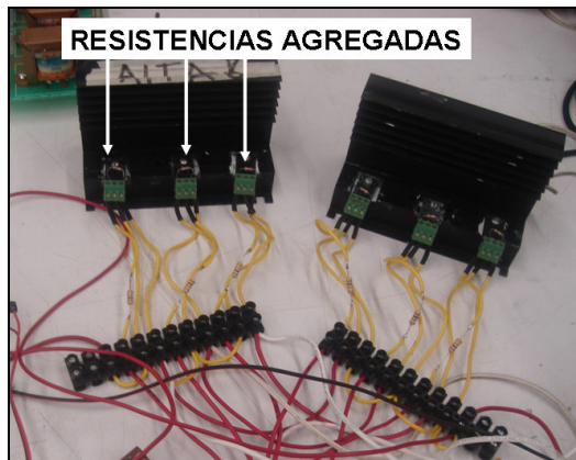
Ilustración 36. Resistencias en Mosfets de alta
