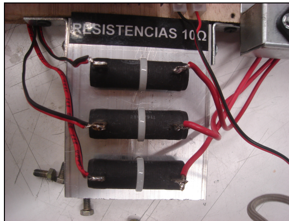
Ilustración 45. Resistencias con disipación
