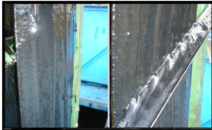
Figura 39. Adherencia de lodos contra banda
