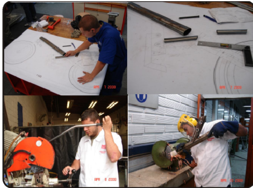
Figura 53. Proceso de corte y pulido de los tubos
