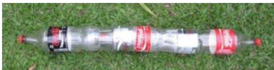
Ilustración 48. Método para unir botellas.
