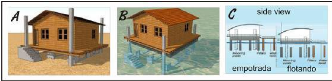
Ilustración 13 CASAS ANFIBIAS A y B vivienda de madera C Plataforma de cemento
