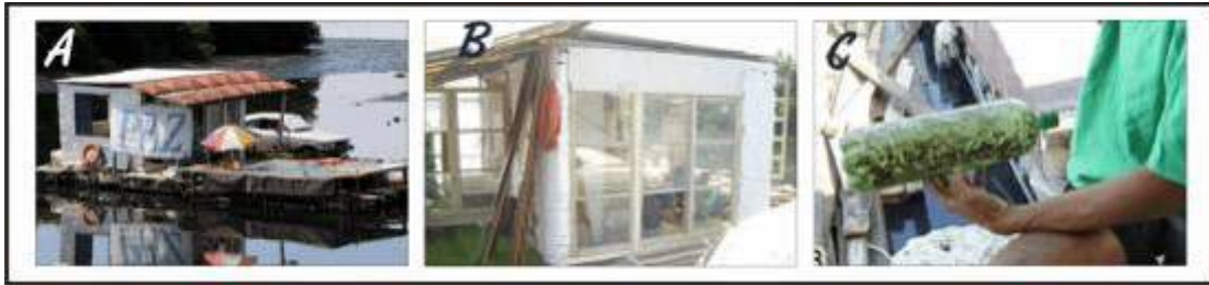
Ilustración 5 Vivienda flotante sobre basura. A. Casa flotante en basura. B. Ventanearía reciclada. C. Botellas rellenas de espumas.
