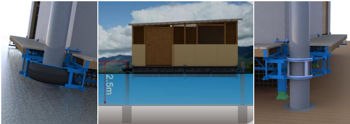
Ilustración 29. Alternativas de sistema de Anclaje
