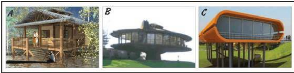
Ilustración 1. A. Vivienda en palafitos de madera. B. Vivienda sobre concreto. C. Pilones de acero.
