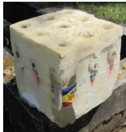
Ilustración 50 Módulo con botellas verticales unidas entre si y fijadas con malla en el pico, Botellas encapsuladas en espuma de poliuretano
