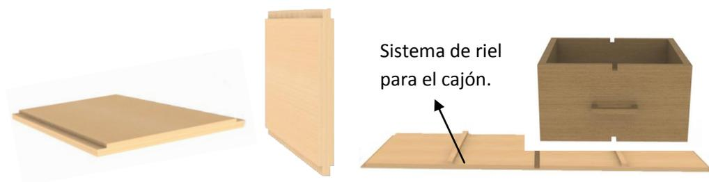
El sistema número 3 está compuesto por paredes iguales con el mismo ensamble del sistema 2, lo cual permite un fácil almacenamiento y personificación de la propuesta.
