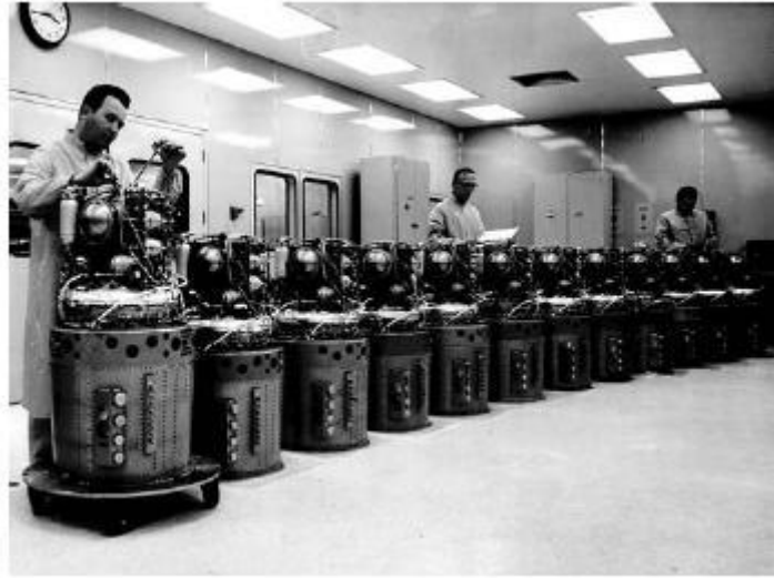
Figura 21. Ensamblaje del sistema de celdas de combustible usadas en la misión Apolo
