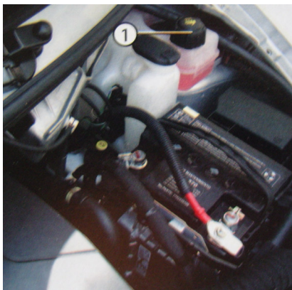
Figura 20. Nivel de líquido refrigerante
