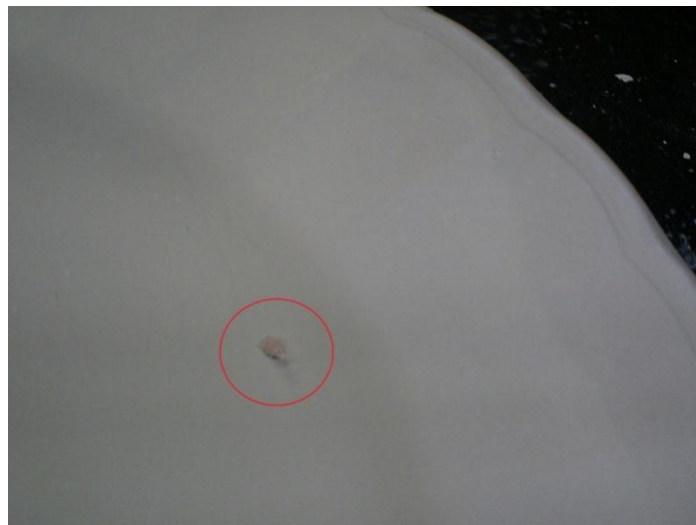
Fotografía 14. Pedazo desprendido de espuma PU Nacional
