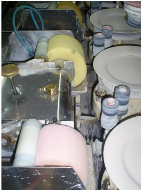
Fotografía 12. Montaje del ensayo de abrasión y desgaste
