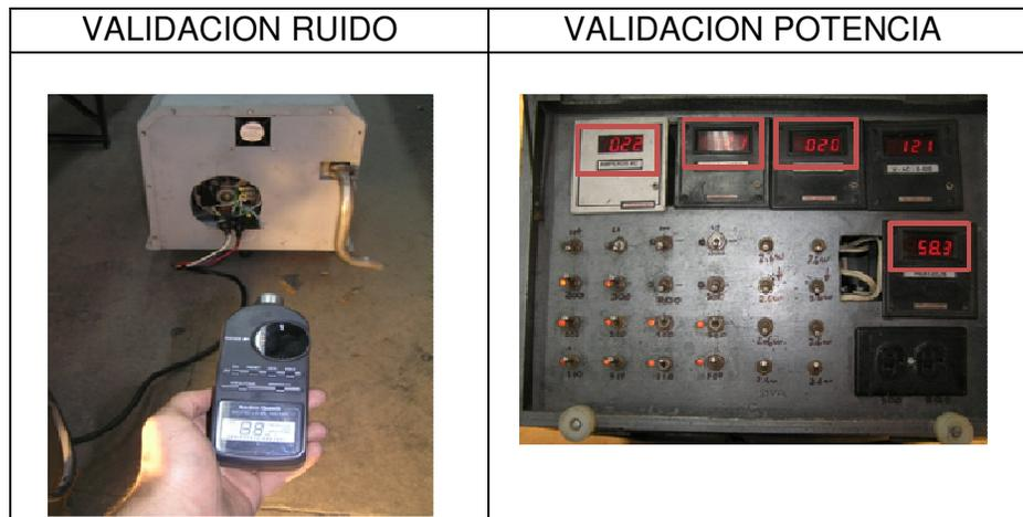
Uno de los criterios de éxito de la función de la cabina es lograr reducir en 30% el nivel de ruido que produce la cabina en máxima carga. La medición del equipo sin cabina con máxima carga a 1 m de distancia generó 100.5415 dB(A).
