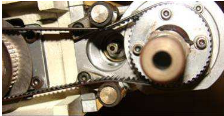
Ilustración 5. Sistema de transmisión por banda de la Muñeca
