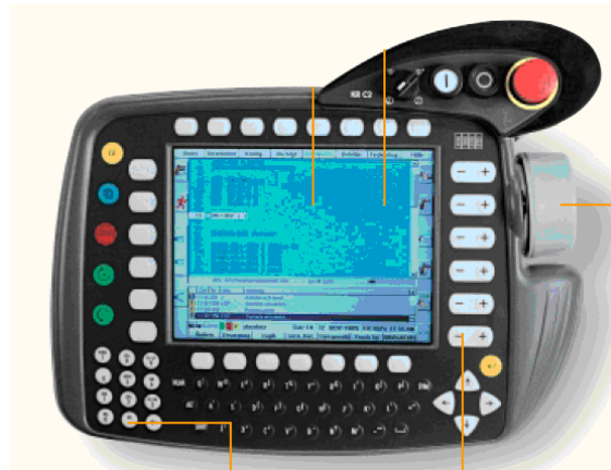
Ilustración 3. Panel de control KUKA para robots industriales
