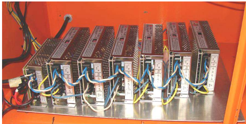
Ilustración 17. Montaje de las fuentes de poder en el robot
