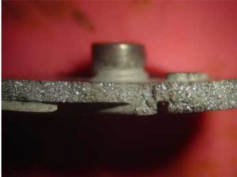
Figura 27. Área de Fractura de una pieza por inyección. 3X
