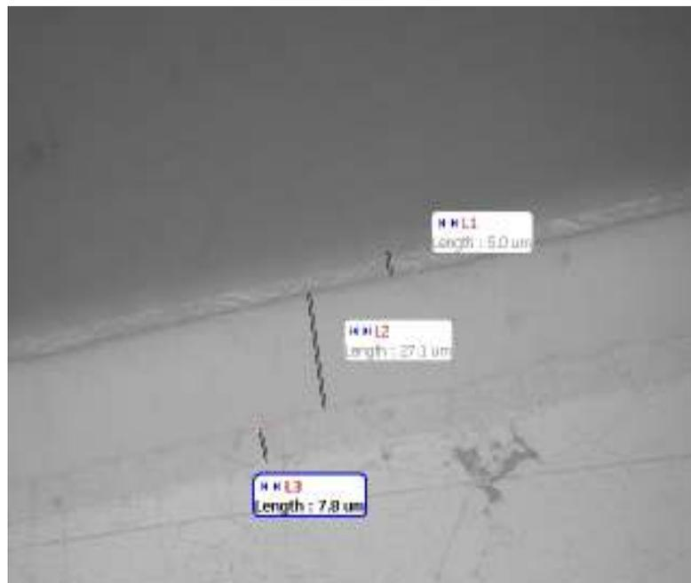
Figura 35. Tercera medición del grosor de la capa obtenida
