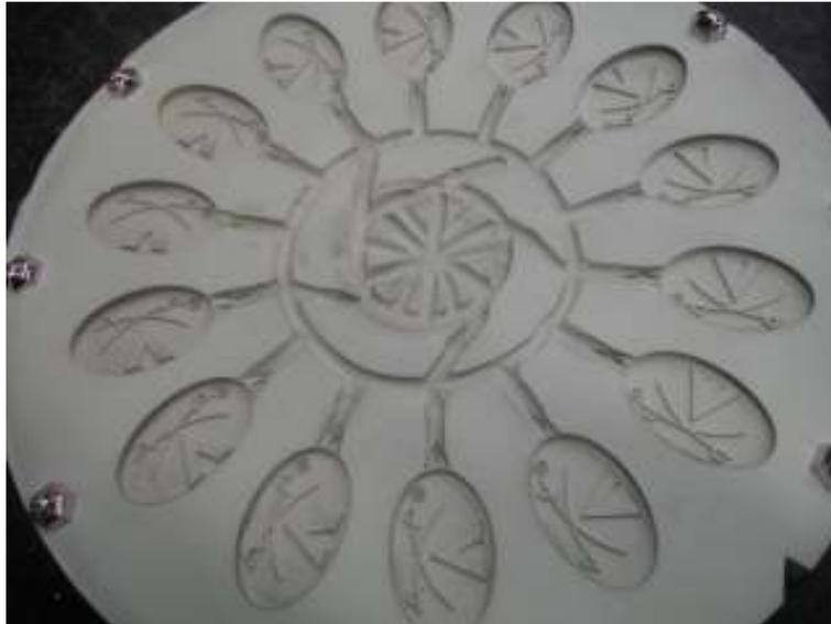
Después de tener el molde completamente listo se procede colocarlo dentro de la centrífuga y al cerrar la puerta el molde será centrado y presionado automáticamente, de esta forma se iniciará el tiempo de centrifugado.
