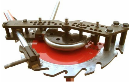
Figura 12. Dobladora hidráulica JD2 Model 4 Tubing Bender
