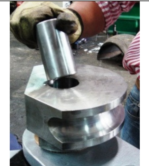
FOTO 12. Posicionamiento del eje del dado
