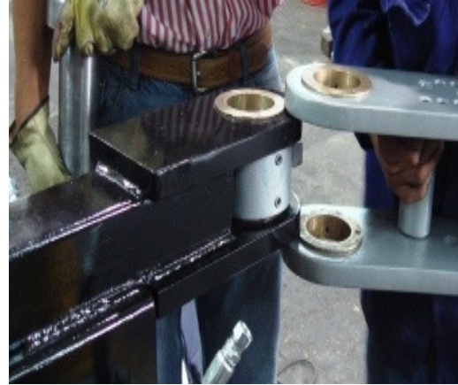
FOTO 9. Posicionamiento de los brazos principales
