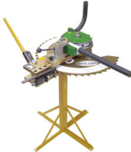
Figura 10. Dobladora Baileigh Bender: RDB-100
