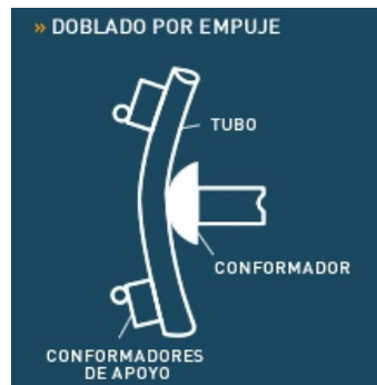
Figura 7. Doblado en prensa o por flexión pura
