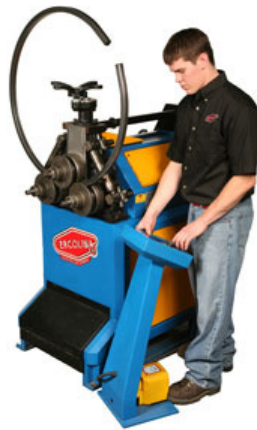
Figura 17. Dobladora a rodillos Ercolina CMR3
