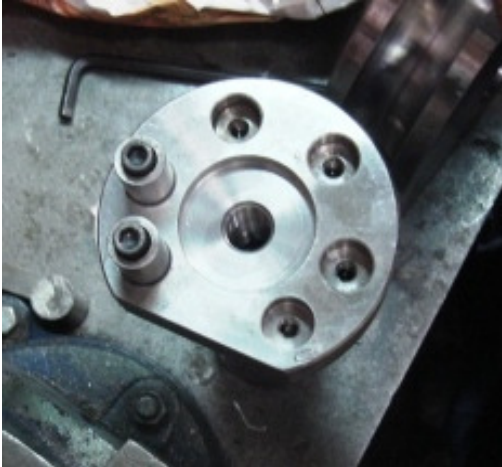
FOTO 11. Ensamble dado con el eje principal
