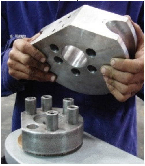
FOTO 11. Ensamble dado con el eje principal
