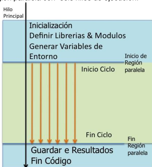
Ilustración 6. Región paralela con seis hilos de ejecución.
