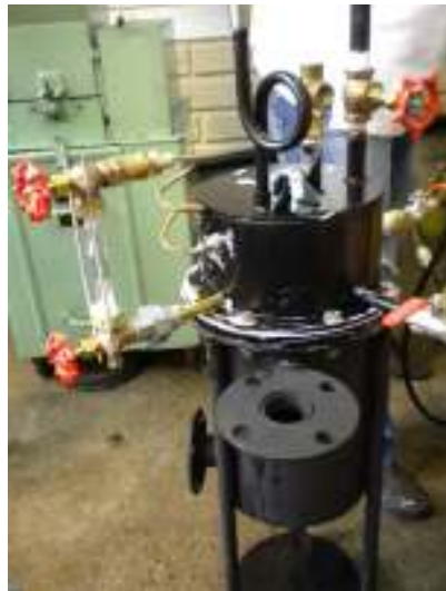
Ilustración 32. Pruebas de estanqueidad
