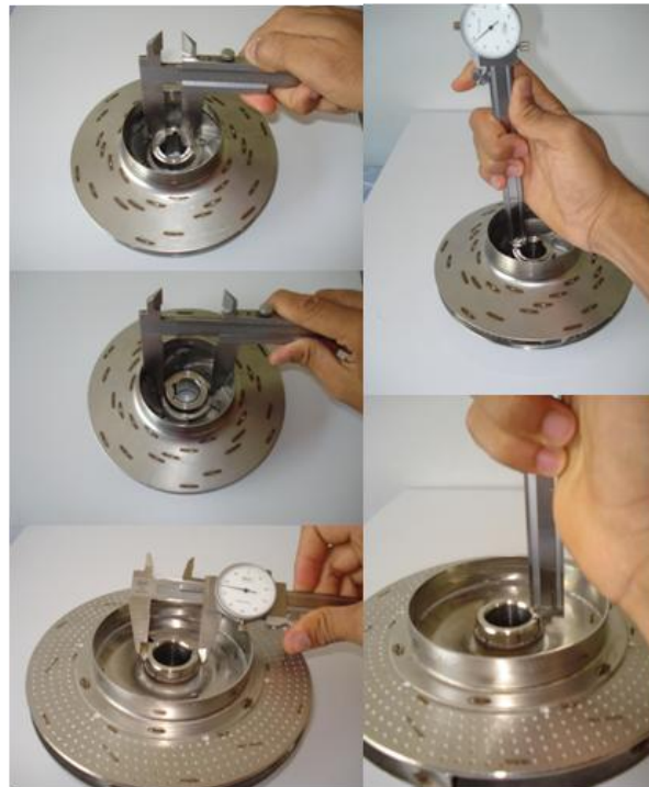
Figura 40. Toma medidas acople del eje
