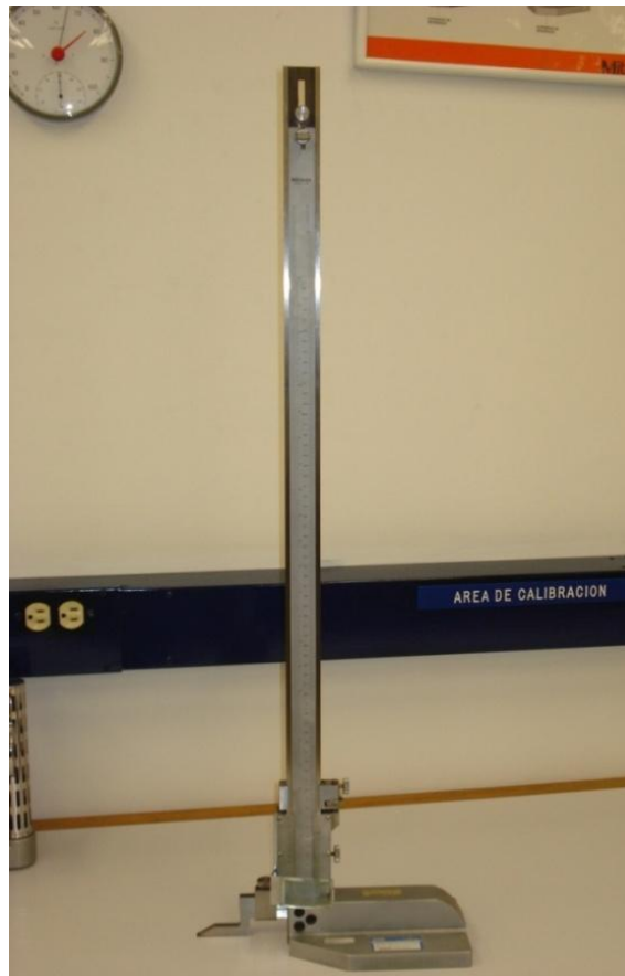
Figura 21. Calibrador de alturas con gramil Mitutoyo
