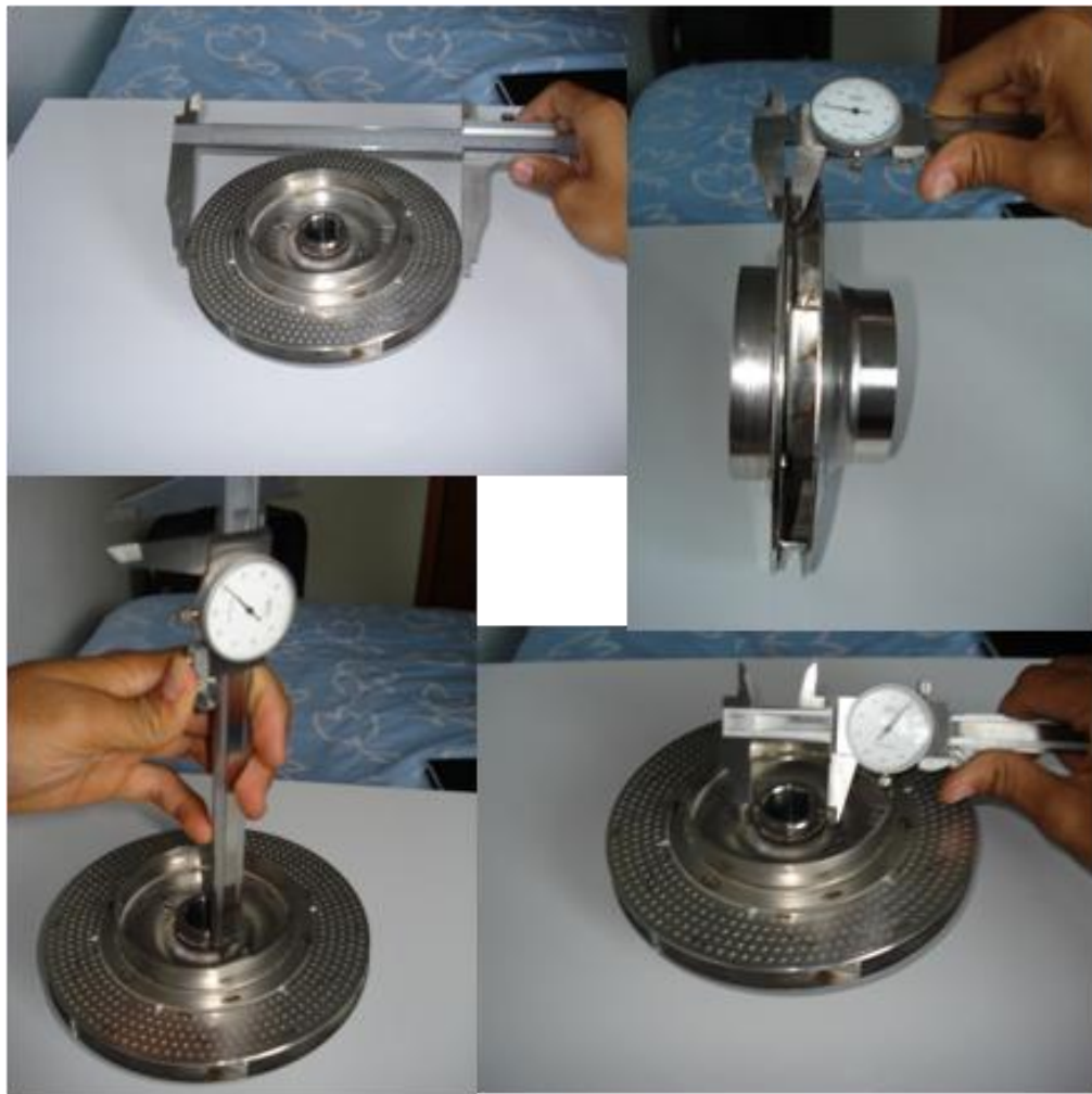
Figura 33. Medición geometría tapa posterior
