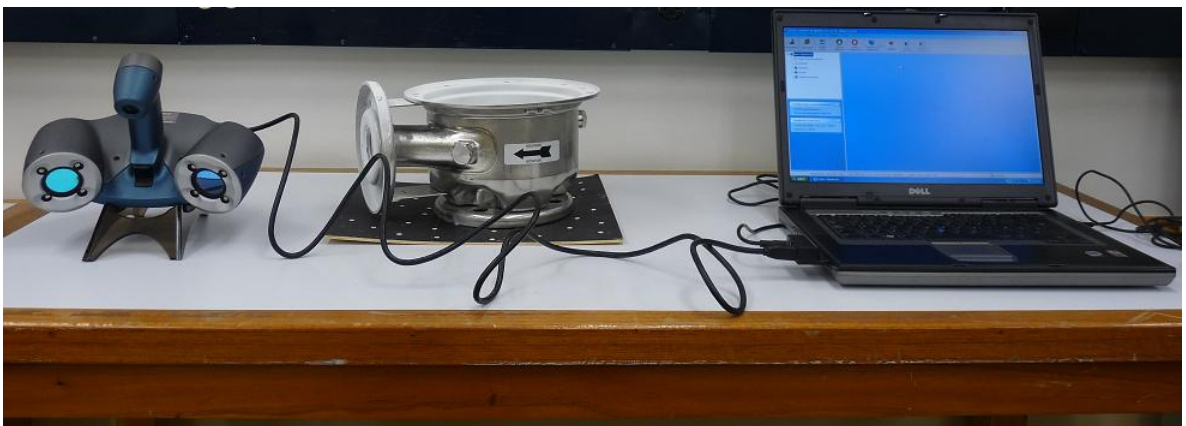
Figura 16. Ejemplo de digitalización con escáner láser
