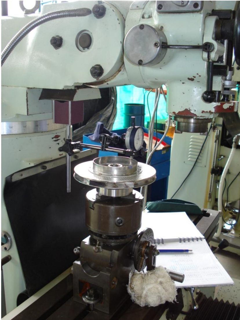
Figura 30. Medición contorno tapa posterior
