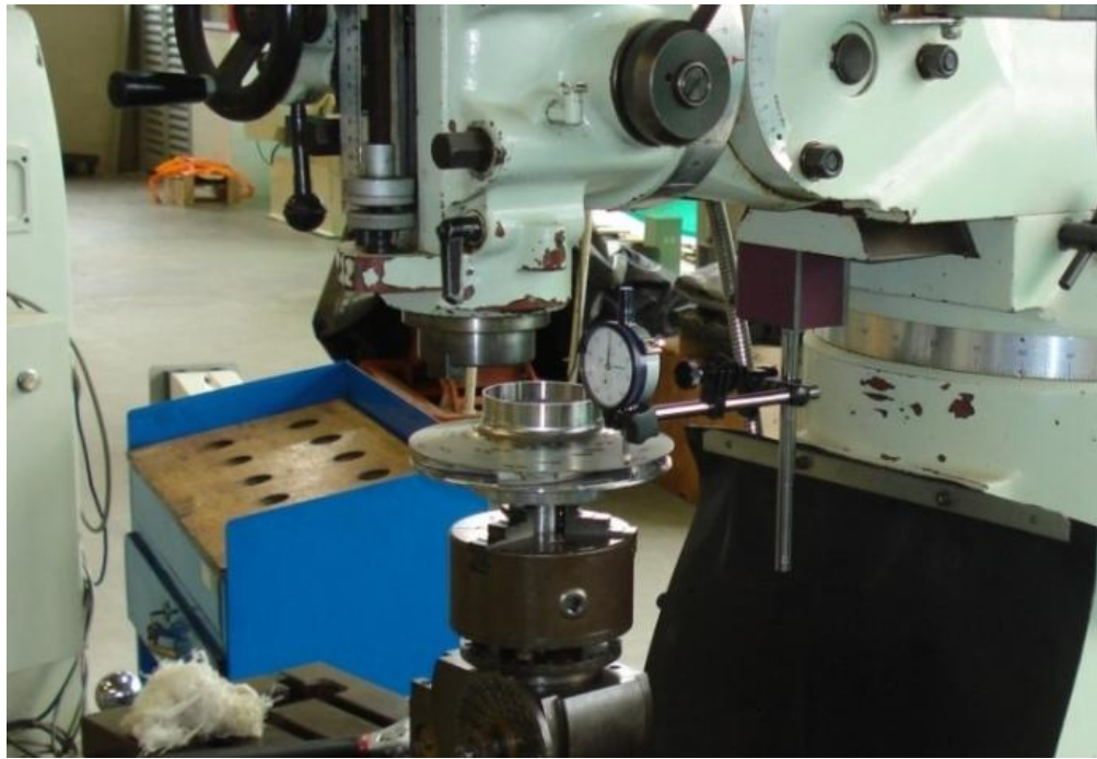
Figura 22. Modo de empleo del reloj comparador
