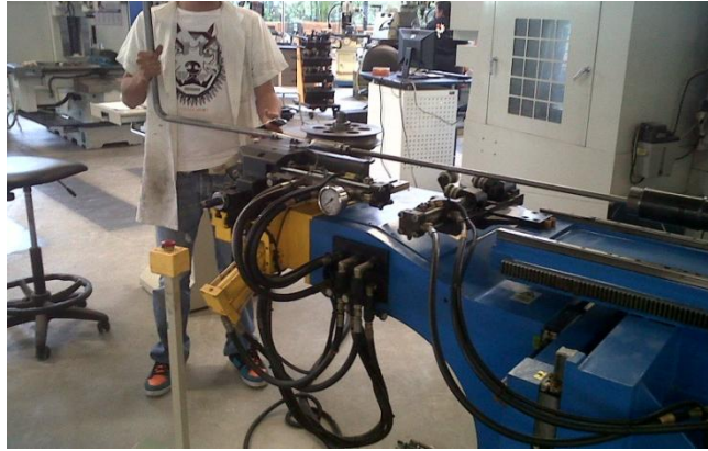
Imagen 45. Doblado de tubería.
