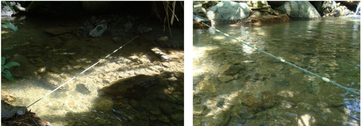
Figura 11 Fotografías de la división de verticales para la quebrada
