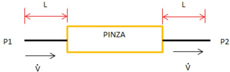
Con los puntos de operación de presión y caudal para cada pinza, extraídos de la información del fabricante, se construye una línea de ajuste, cuyos parámetros son la pendiente y el intercepto. De esta manera, se puede determinar la pérdida hidráulica impuesta por la pinza para la operación con distintos caudales.
