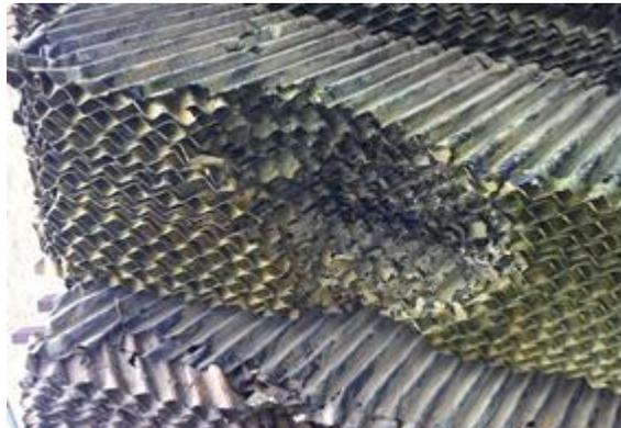
Los evaporadores en buen estado son lavados con agua a presión y son montados de nuevo, mientras se realiza un pedido de nuevos evaporadores.
