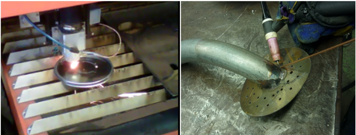
Ilustración 52. Lamina en la cortadora laser
