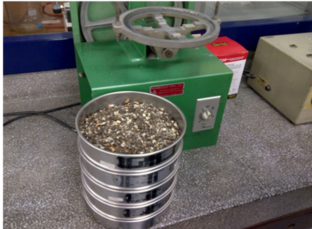
Ilustración 13. Muestra y Juego de tamices
