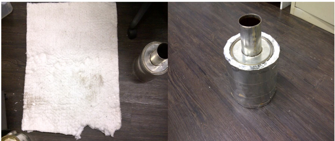
Ilustración 43. Cámara recubierta con el aislante
