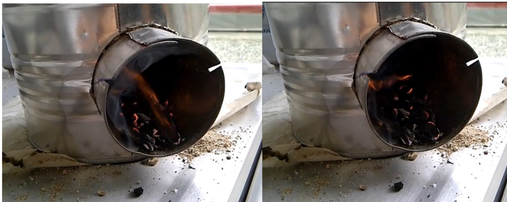
Ilustración 36. Quema de cáscara en el borde del ducto
