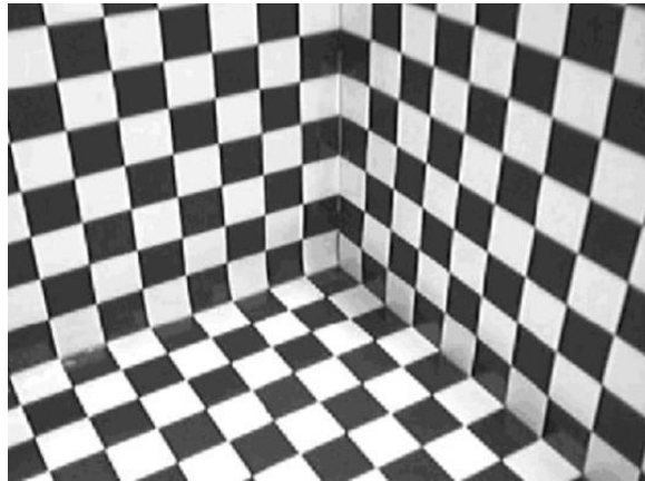
Figura 11. Plantilla 3D para la calibración de la cámara [6].
