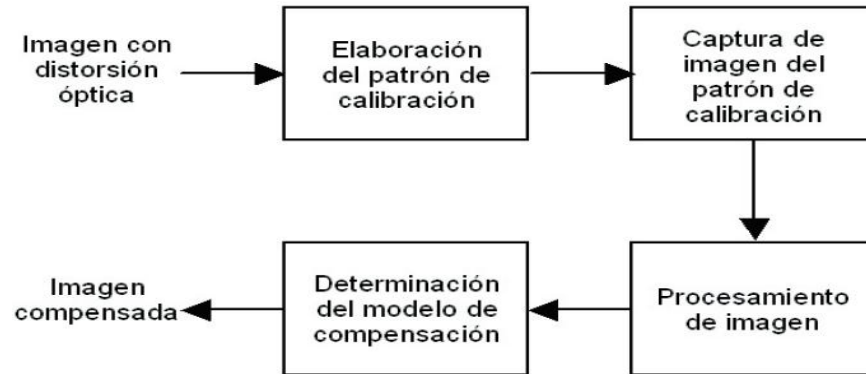
Figura 13. Procedimiento para la compensación de la distorsión óptica de las imágenes [1].
