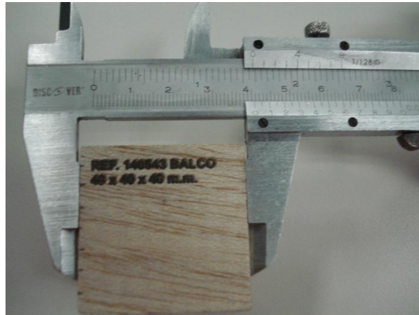
Figura 37. Medición de los diferentes puntos con el pie de rey.
