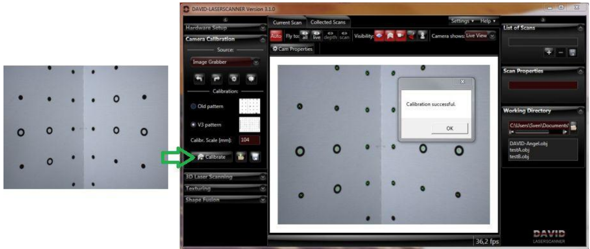
Figura 29. Calibración de la cámara.
