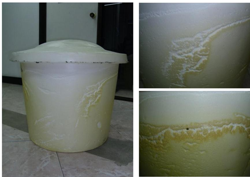
Figura 16: Primer prototipo fabricado; Trampa de grasas. Fuente: Los autores.
