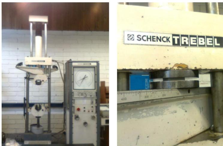
Figura 7: Equipo utilizado y montaje de la prueba de compresión. Fuente: El autor.
