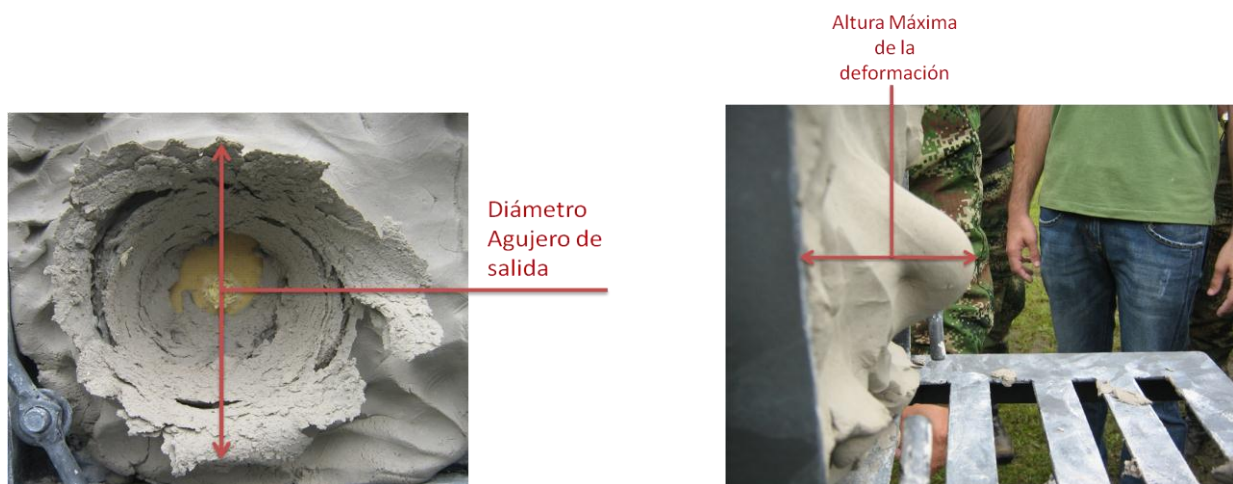
Figuras 24 y 25. Medición del agujero de salida para materiales perforados (Izquierda) y medición de la altura máxima de deformación en la arcilla para materiales no perforados (Derecha)
