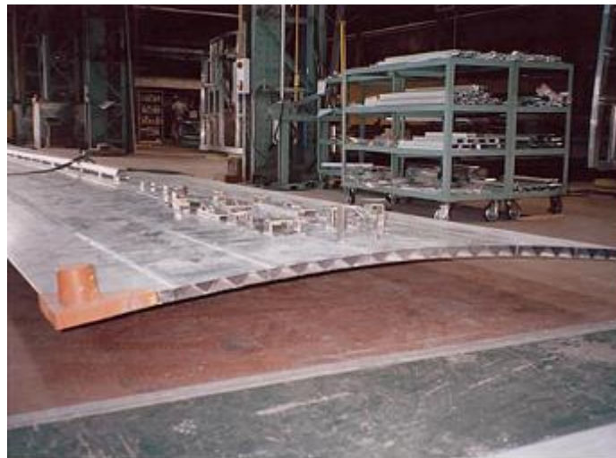
Ilustración 31. Superficie exterior de una estructura de techo de doble piel completado
