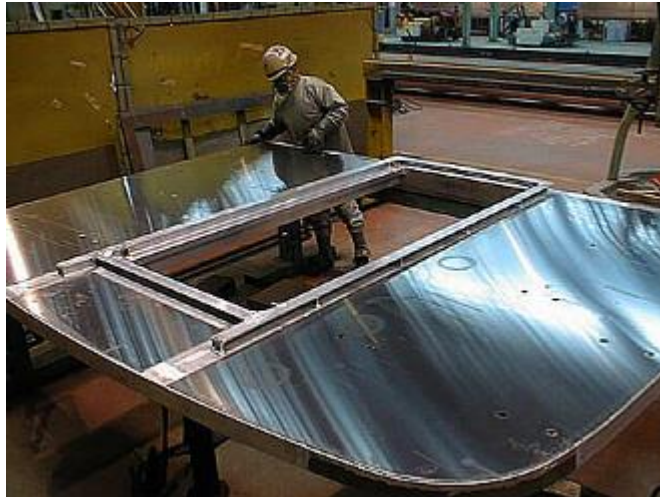
Ilustración 32. Una estructura final después de los procesos de embarque
