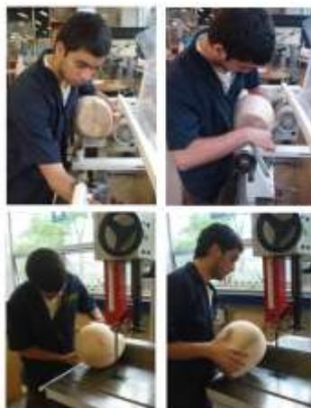
Imagen 26. Torneado y corte del molde
