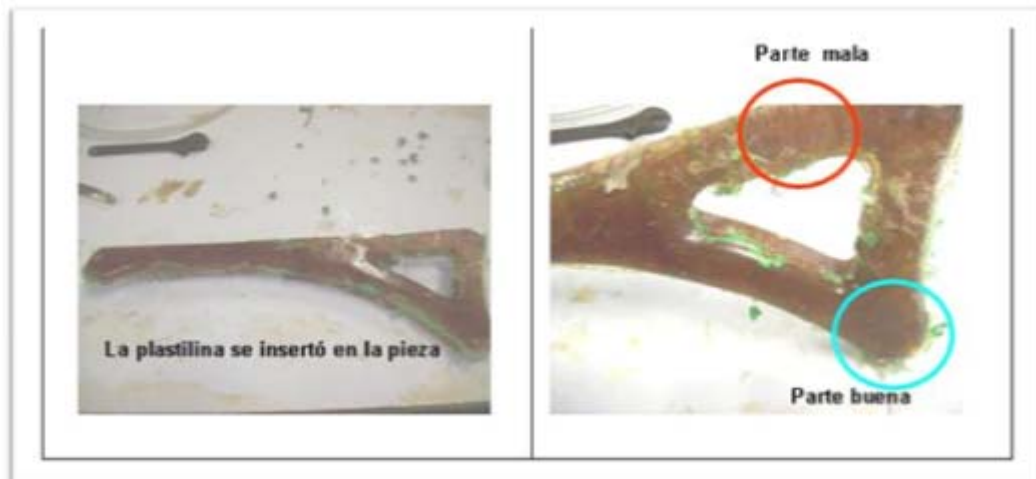
Imagen 42: Prueba inyección por LRTM
