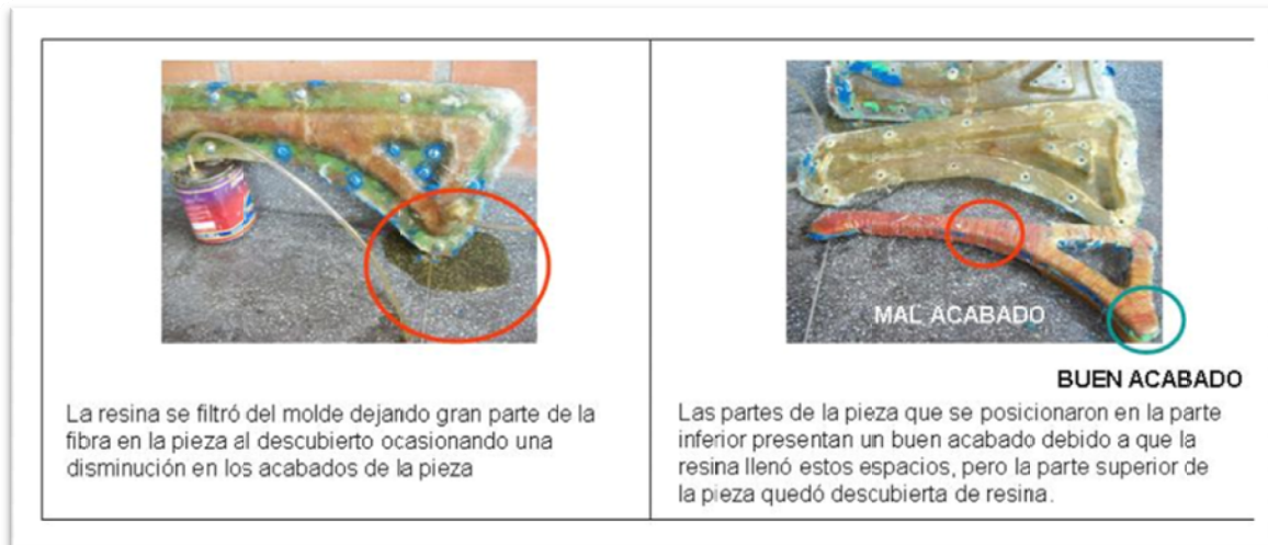
Imagen 44: Fallas en las pruebas realizadas.
