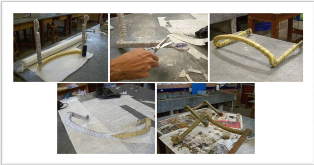
Imagen 32: Aplicación de las capas de fibra de vidrio y resina.
